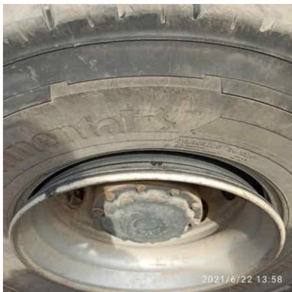
Следы перекрытия на колесе грузовика
