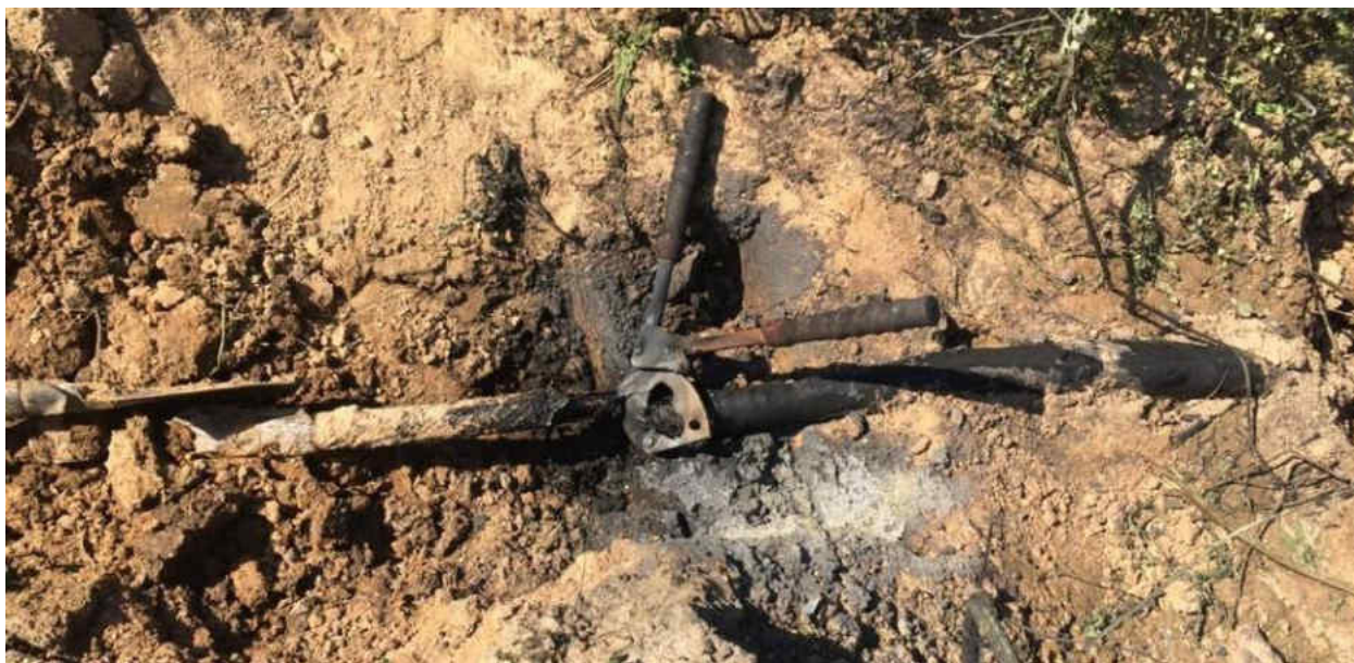
Ножницы для резки кабеля на месте несчастного случая.
