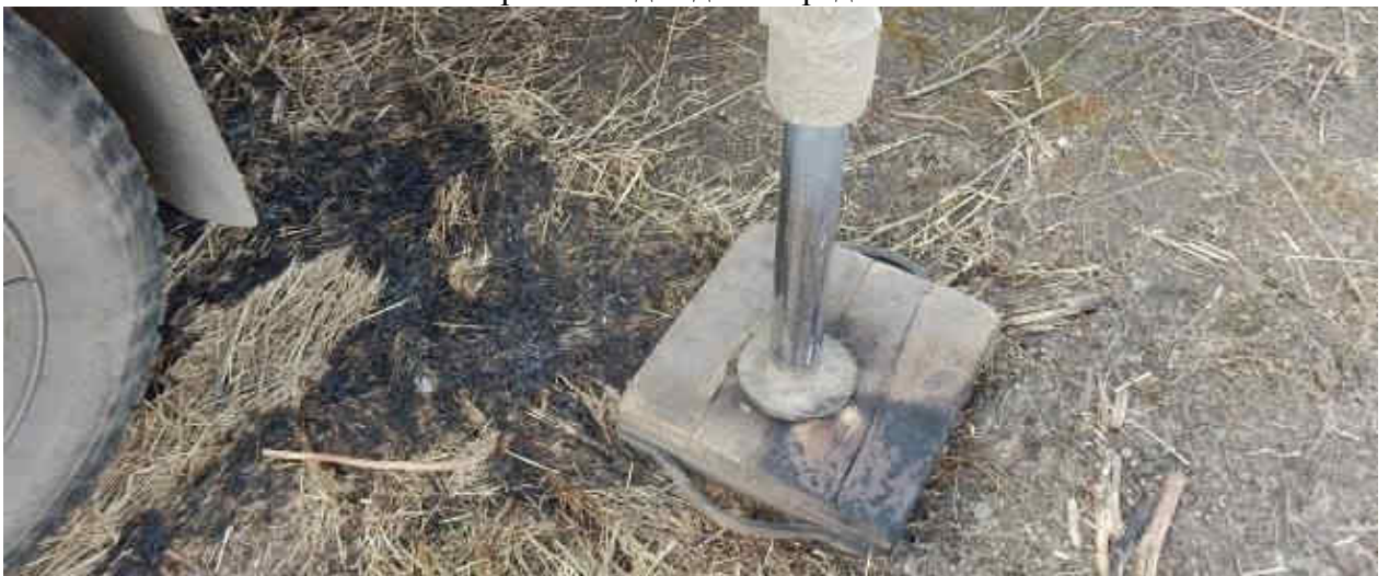
Аутригер манипулятора со следами протекания тока КЗ
