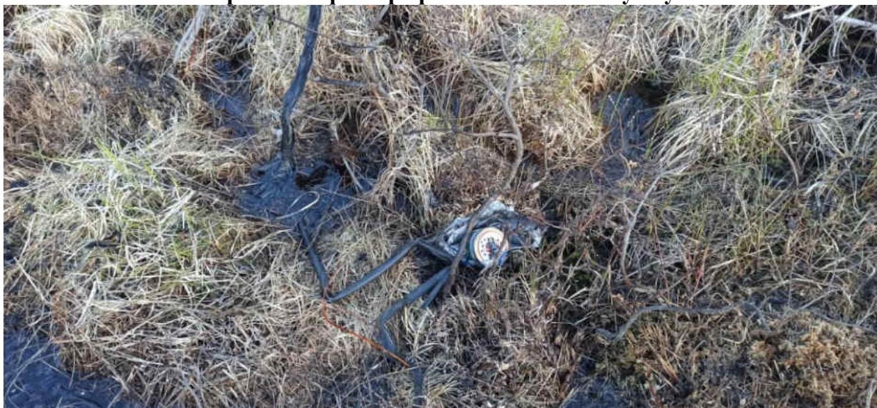
Удилище со следами воздействия электрической дуги.
