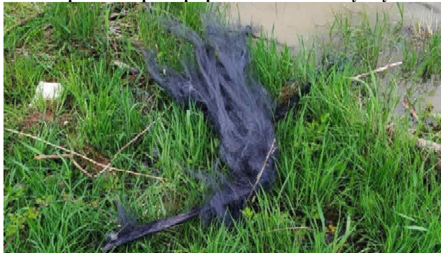
Удилище со следами воздействия электрической дуги
